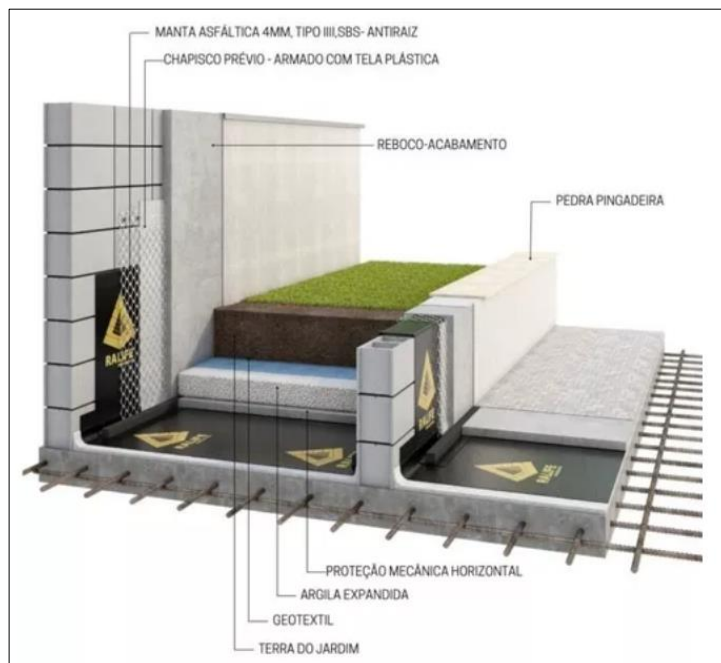
Imagem 27 - Exemplo das camadas e aplicação de um sistema
